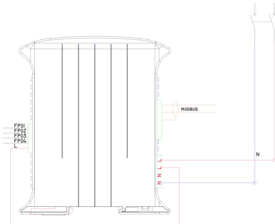
Figure 1: Schéma global de raccordement FpControler®
